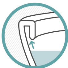
AVEC BRIDE L'eau de chasse est propulsée dans la zone en U située en haut de la cuvette
